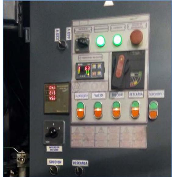
**MAQUINA DE TERMO VACÍO PARA TRATAMIENTO, EXTRACCIÓN DE LA HUMEDAD E IMPUREZAS PARA LA REGENERACION DEL ACEITE DIELECTRICO DE LOS TRANSFORMADORES.**
